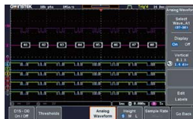
數位訊號轉換為類比波形的顯示
