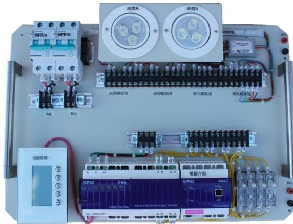
※ 實驗器含有開關模組、電驛模組、電腦介面、炭燈、炭燈驅動器、LED RGB 燈條、燈條驅動器、訊號解碼器、無熔絲開關及儲存鋁箱。
