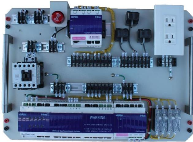
※ 實驗器配有：電流量測模組、鉗形比流器、電磁接觸器、警報蜂鳴器/指示燈、單相雙插座、數位調光模組、彩色調色模組、器具板及儲存鋁箱。
