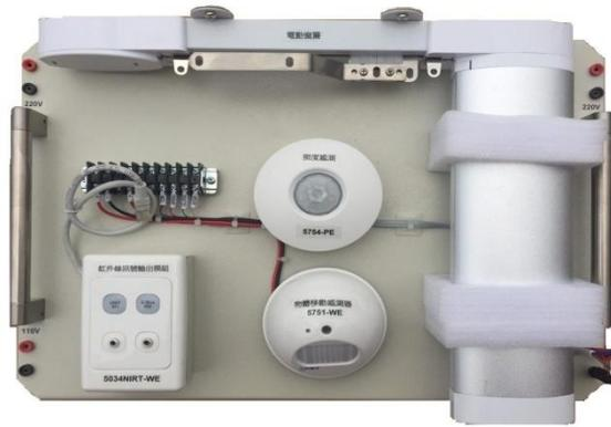
※ 實驗器配有紅外線輸出模組、紅外線發射器、紅外線傳輸線、Motion 紅外線感測器、光感應器(照度)、電動窗簾、器具板及儲存鋁箱。
